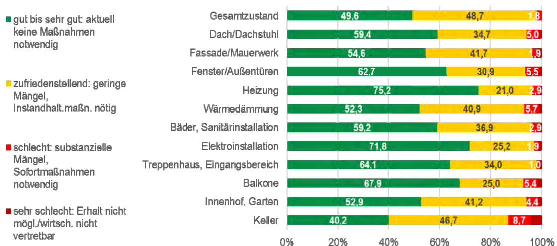
Abbildung 11: Bewertung des baulichen Zustands der Objekte
