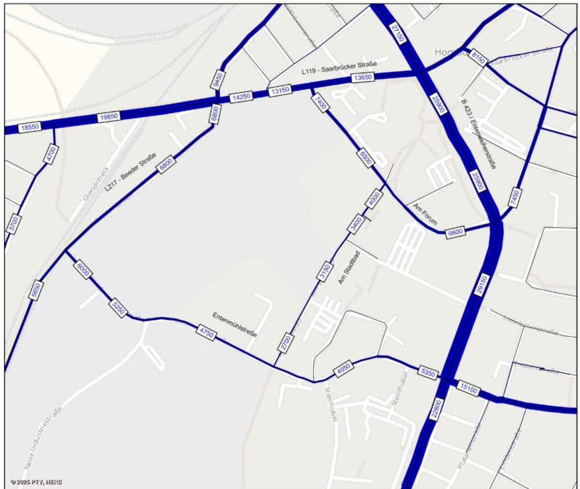
Abbildung 6: Fall 1 – Verkehrsbelastungen in Kfz/24h
