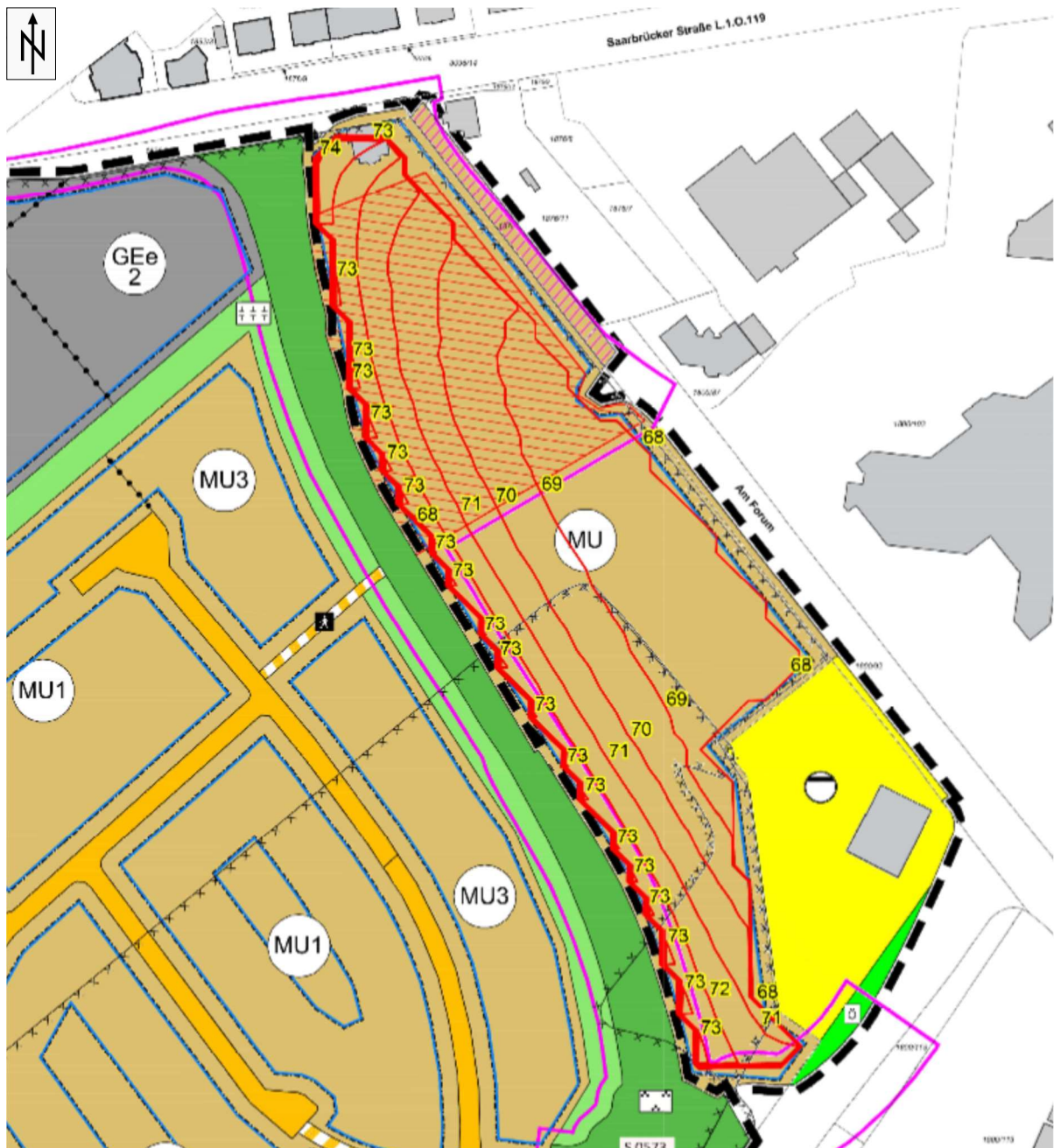
Bild 11b Maßgebliche Außenlärmpegel Immissionsorte mit ausschließlicher Tagnutzung – Fall 3 – 1. BA Berechnungshöhe 8,4 m (2. OG) Maßstab 1:2.000
