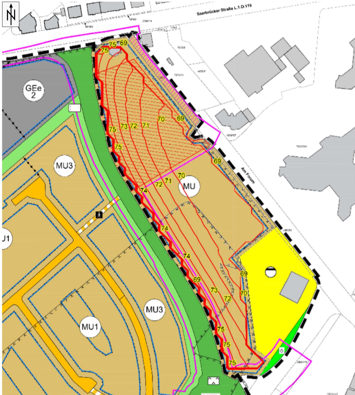
Bild 11a Maßgebliche Außenlärmpegel Immissionsorte mit Nachnutzung – Fall 3 – 1. BA Berechnungshöhe 8,4 m (2. OG) Maßstab 1:2.000
