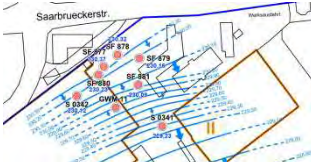
Abbildung 1: nördlicher Ausschnitt Grundwassergleichenplan (Stichtagsmessung 10/2018)
