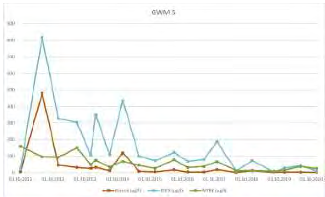
Abbildung 2: Schadstoffkonzentrationsverlauf von Benzol, BTEX und MTBE in µg/l von 2011-2021 der GWM 5 (SF 877)
